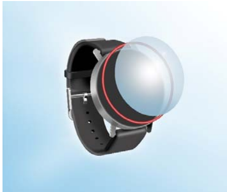
图 1：对智能手表外壳上的触摸屏进行防水密封。使用 Manz 的解决方案，红色粘合剂完全自动装填并进行激光激活，再将盖板玻璃在上方压合。
