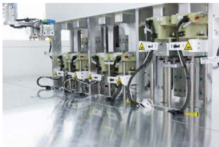
图 2：Manz 显示屏密封系统上料装置，配备三个可变换且具缓冲的预加热冲压单元。
