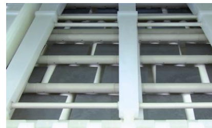
Mit der Anlage wird die hochdotierte Schicht von der Rückseite und den Kanten des Wafers chemisch entfernt und damit der Emitter von der Rückseite isoliert.
