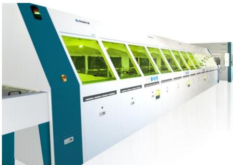
Die neue Nasschemie-Prozessanlage IPSC CEI 4800 von Manz schafft 4.800 Wafer pro Stunde.
