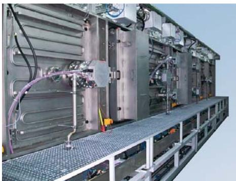
Foto: Mit einer Vakuum-Anlage zur Beschichtung von Substraten komplettiert der Hightech-Maschinenbauer Manz sein Angebot für den Dünnschicht-Solarmarkt.
