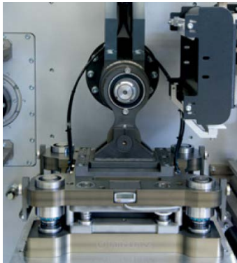
Bild 1: Das Prozessmodul der Highspeed Notching Platform von Manz beherrscht unterschiedliche Notching-Verfahren – mittels mechanischem Schnitt oder auch Laserschneiden.
