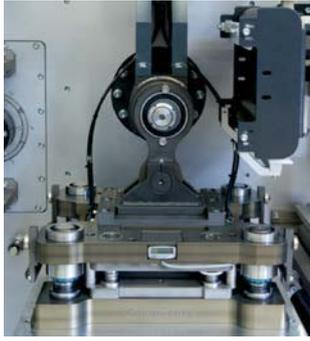
圖 1：軟包式鋰離子電池標準生產線的一部分：Manz 的高速模切平台是製造單一電極或電極網的高效解決方案。
