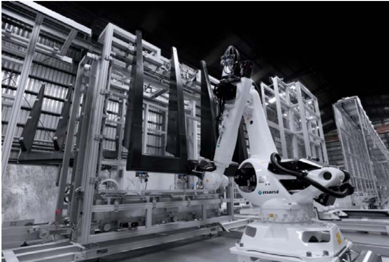
圖 1: Manx 亞智科技機器手臂處理系統用於 HKC G8.6 基板傳送。
