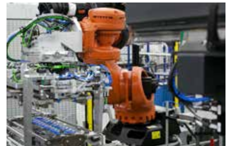
Hocheffiziente Anlagen zur Batteriezellen- und Modulfertigung
