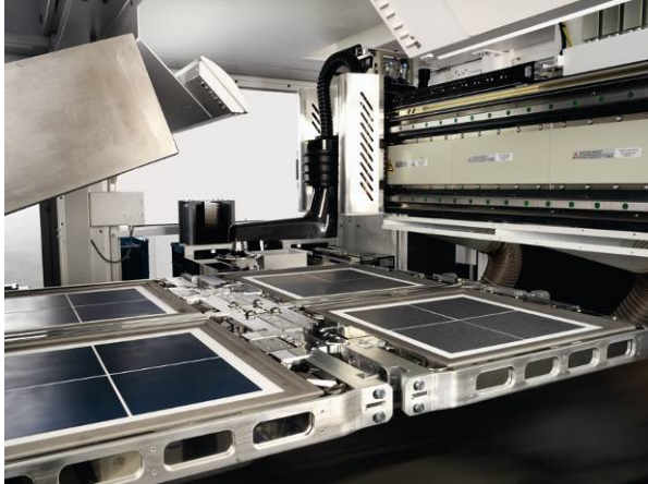
PECVD-Anlage VCS 1200 für Siliziumwafer
