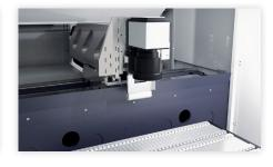
粉末压铸成型后, 利用视觉定位, 实现在烧结托 盘上的精准摆放。并且通过 HMI 人机界面对工 件的摆放位置进行编辑。烧结托盘的样式也变 得简单, 无需过多工序
