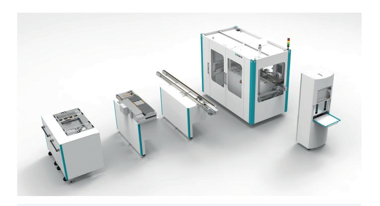
基于标准模块, CPA 800 提供了多种不同的配置选项。仅预定义了外壳, 信号灯, 控制面板和电子设备。可以根据模块化原理来选择所有其他组件, 以适合您所需的特定模型。
