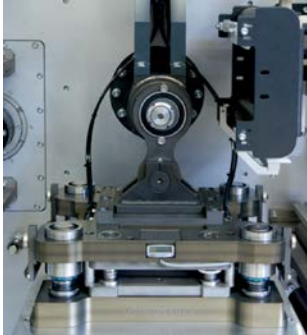
Bild 1: Bestandteil der Standard-Produktionslinie zur Herstellung von laminierten Li-Ion Pouch-Batteriezellen: Mit der Highspeed Notching Plattform bietet Manz eine hocheffiziente Lösung zur Herstellung von einzelnen Elektroden oder Elektrodenbahnen.
