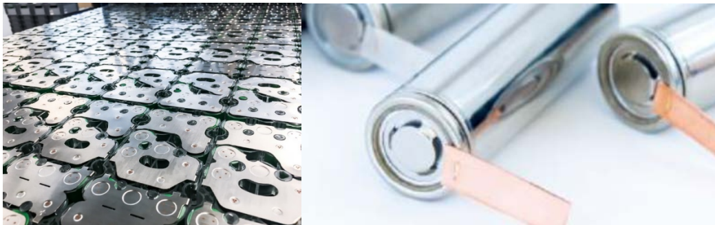
Abbildung 2: Kosteneffiziente Massenfertigung nur mit Automatisierung: verschweißte Kupfer-Ableiter mit Nickelschicht an Lithium-Ionen-Batteriepacks.
