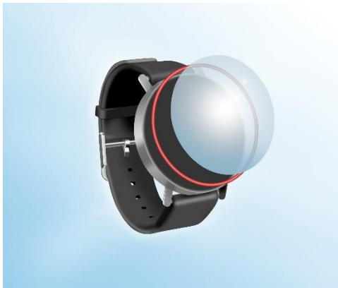
Abbildung 1: Touch Displays werden auf dem Gehäuse einer Smartwatch wasserdicht versiegelt. Bei der Lösung von Manz wird das rote Klebelement vollautomatisch zugeführt, per Laser aktiviert und anschließend das Deckglas aufgepresst.
