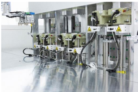
Abbildung 2: Beladeschnittstelle der Display-Versiegelungsanlage von Manz mit drei alternierend und gepuffert zu beladenden, vortemperierten Presseeinheiten.
